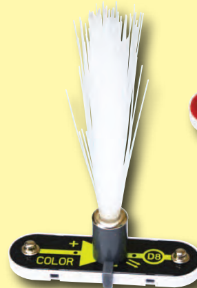
Arbre de fibres optiques assemblé avec D8
